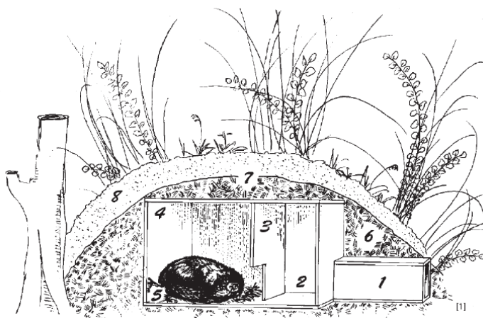
Figuur 6.2. Principe van een gecompartmenteerd marterhuis, in dit geval overdekt met aarde en beplanting. (Bron: Altrock et al.).
